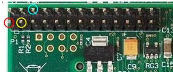
RPi Modell B Rev 2.0 Anschlussleiste P1 Rot Pin1 3,3V / Gelb Pin3 GPIO 2 / Hellblau Pin6 Masse
